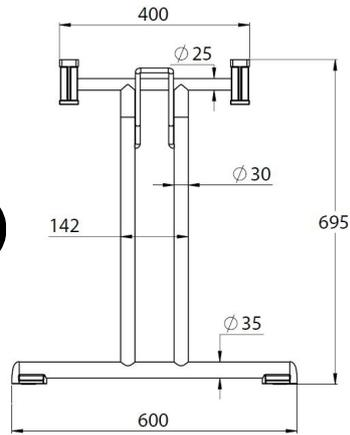
2x stabiles Klappgestell mit Schnappverschluss aus glasfaserverstärktem Polyamid
