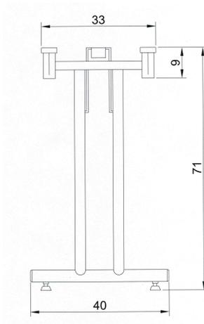
stabiles Klappgestell mit Metall-Schnappverschluss
