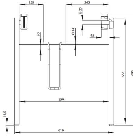
stabiles Klappgestell mit Schnappverschluss aus glasfaserverstärktem Polyamid
